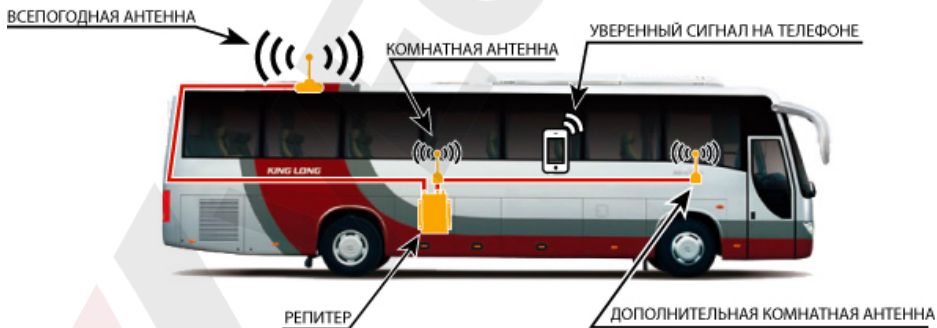
Схема №1. Пример установки репитера в автобусе.
